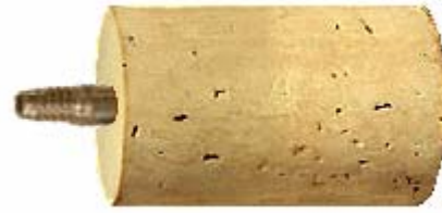
Abb. 3: Korken mit Fahrrad-Blitzventil. Der Korken ist der Länge nach durchbohrt, um den ungehinderten Lufteintritt zu ermöglichen.
