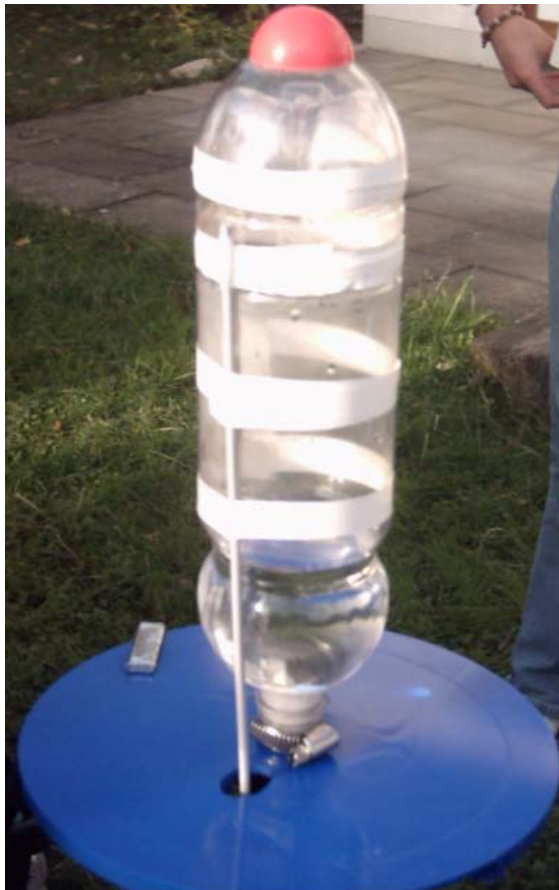
Abb. 1: Wasserrakete aus PET mit "Nase", Alu-Stab als Leitwerk, 250 ml Wasser Füllung und Gartenschlauch-Schelle als Abdichtungshilfe. Als Startrampe dient die Basis eines Theodoliten. Die Luftzufuhr erfolgt von unterhalb der blauen Platte.
