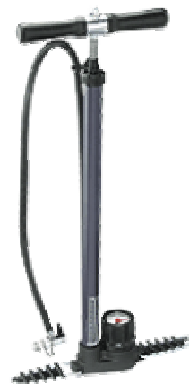
Abb. 2: Fahrrad-Luftpumpe, Typ: Rennkompressor, max. 16 bar, mit Manometer, 120 cm Hochdruckschlauch und AVACS Schlauchanschluß.
