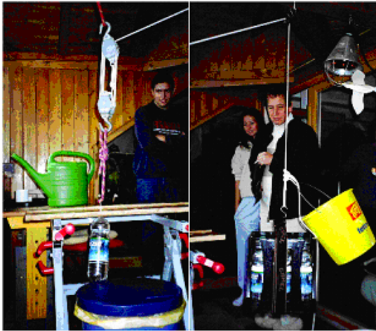
Abb. 8: In eine Werkbank locker von unten eingefügte Wasserflasche kurz vor der Entkorkung. Man beachte den mit 50 l Wasser gefüllten Mülleimer (plus 20 kg Backsteine im Hintergrund) als Gegengewicht.
